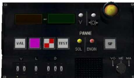
L'isolement KVB doit être sur arrêt, pour faire apparaître ces données il faut faire tourner les molettes à l'aide de la touche « B », les molettes 1 et 2 indiquent la vitesse, la molette 3 indique la longueur (pour le X2200 ce sera 1 qui correspond à 100m pour mettre plus il faudrait par exemple une composition de 3 motrices et 2 remorques), les molettes 4, 5 et 6 indiquent le coefficient de freinage.
