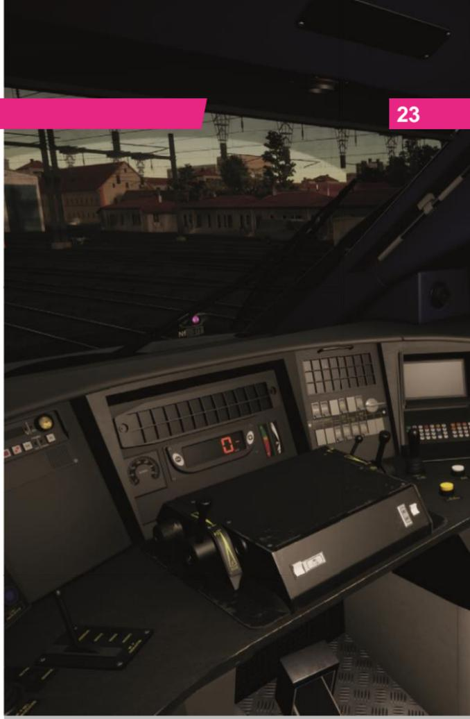
Le TGV Duplex Série 200 SNCF est un train multi-courants, ce qui signifie qu'il peut tirer du courant de différentes intensités sur une multitude de systèmes caténares. On trouve en Europe une multitude de types de courant électrique, et comme les TGV traversent différent pays, il est important qu'ils puissent utiliser le courant utilisé dans chacun de ces pays.
